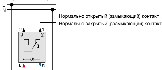
Кнопочный переключатель с подсветкой (Применение: если реле лестничного освещения управляется током контрольной лампы)
