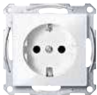
Розетка с заземлением, без шторок, без рамки, 16А, 250В
